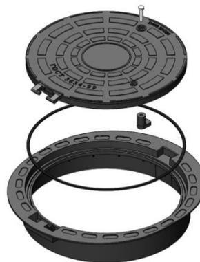
Конструктивно сооружение состоит из двух элементов: корпуса с опорными частями и крышки. Канализационный плавающий люк предназначен для оперативного доступа к подземным коммуникациям. Чугунный люк плавающего типа активно применяется в дорожном строительстве с целью сохранения асфальтового покрытия от разрушений, связанных с проседанием грунта.
