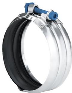
Хомуты Rapid имеют название из-за скорости монтажа (один крепежный винт). Также могут нести осевую нагрузку 0,5 бар. Применяется на безнапорных системах.
