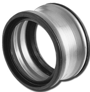
Манжета **SVE** предназначена для соединения труб, прокладываемых в основном вне помещений. Использовать соединитель SVE возможно в любых типах грунтов, допустимо использование манжеты во внутренних помещениях зданий. Благодаря эластичности прокладок и герметичности соединения, между торцами труб допустим значительный зазор, для разных диаметров он составляет от 5 мм до 100 мм.
