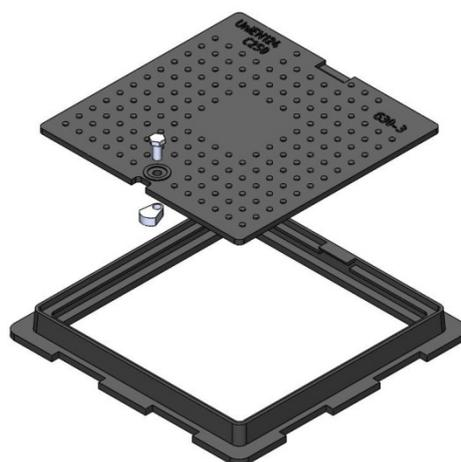
Применимы на всех городских сетях. Имеют класс нагрузки от С250 до Е600. Особенностью конструкции всех люков является запорный элемент, скрытый шарнир, резиновое кольцо-уплотнитель и отверстие для замера газов. Вся продукция соответствует требованиям стандартов ГОСТ 3634-99 и EN 124.
