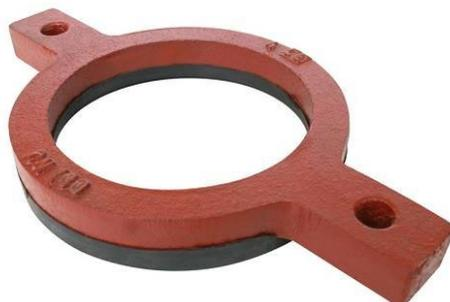
Безраструбное опорное кольцо — это деталь чугунной канализации SML, которая используется вместе с опорной чугунной трубой для стояков при создании точек опоры трубопровода в вертикальных плоскостях протяженностью более 12 метров.
