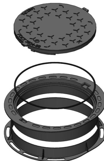
Конструктивно сооружение состоит из двух элементов: корпуса с опорными частями и крышки. Канализационный плавающий люк предназначен для оперативного доступа к подземным коммуникациям. Чугунный люк плавающего типа активно применяется в дорожном строительстве с целью сохранения асфальтового покрытия от разрушений, связанных с проседанием грунта.
