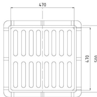
Изготавливаем под заказ решетки и глухие крышки из высокопрочного чугуна монтирующийся на бетонные водоотводные лотки и каналы внутренним сечением DN150-500. Класс нагрузки А15-Ф900.
