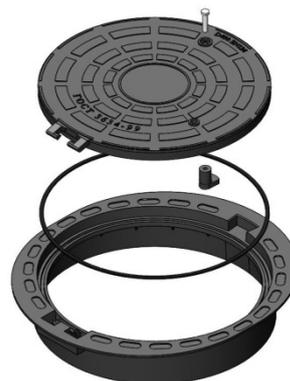
Конструкционно сооружение состоит из двух элементов: корпуса с опорными частями и крышки. Канализационный плавающий люк предназначен для оперативного доступа к подземным коммуникациям. Чугунный люк плавающего типа активно применяется в дорожном строительстве с целью сохранения асфальтового покрытия от разрушений, связанных с проседанием грунта.
