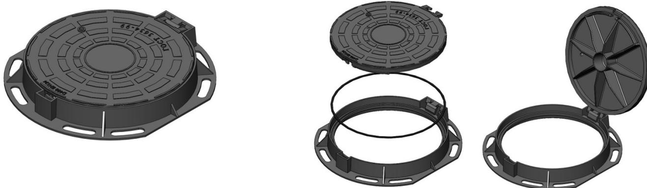
Канализационный круглый люк на шарнире с запорным устройством представляет собой конструкционный элемент, который устанавливается на колодцы городских магистральных сетей и автотрасс. Чугунный люк на шарнире позволяет фиксировать крышку над смотровым колодцем в открытом положении, что избавляет обслуживающий персонал от необходимости ее снимать каждый раз, когда нужно попасть внутрь.
